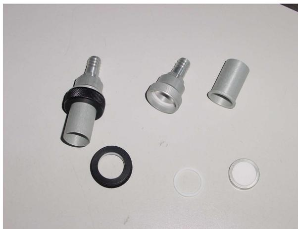
Figura 5. Linea di campionamento per amianto
